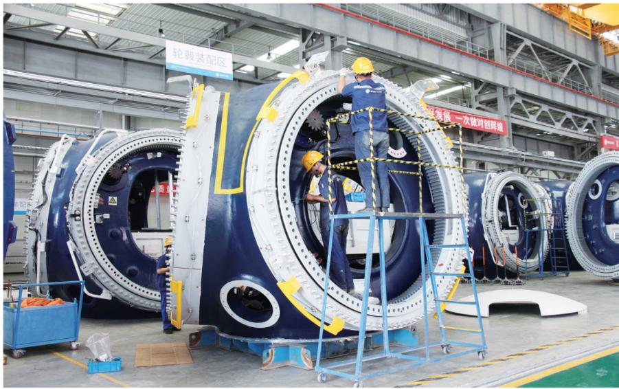
酒泉市是全国风能资源最为丰富、开发条件最为优越的地区之一。基于酒泉市新能源产业发展规划,2022年12月,明阳智慧绿色能源装备制造产业园项目建成投产,分期建设大型半直驱风机总装、锻造件、储能、电气设备等项目。项目全部建成后,预计可实现年产值100亿元,带动就业1000人。图为甘肃明阳智慧能源有限公司员工正在进行轮毂装配。
